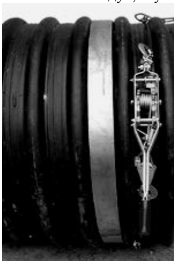
Рисунок 15. Стягивание лент при помощи лебедки.
